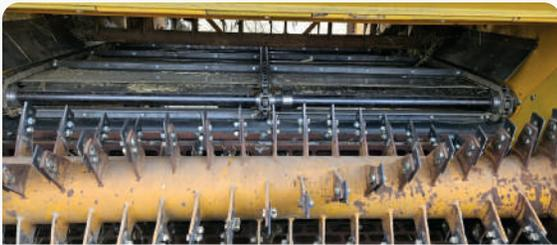
Reforma: nuevo acarreador a cadenas, sustituyendo el antiguo acarreador de lona engomado
